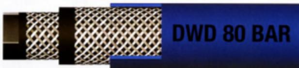
Kälteflexible Rebspritzschläuche aus Weich-PVC mit Polyesterreinlagen. Seele schwarz, außen blau, glatt. Schwere Ausführung, knickfest und drallfrei. Temperaturbeständig von -20 bis +60°C. Geeignet für Pestizide, leicht alkalische Flüssigkeiten, Frischwasser, Seewasser, öhaltiges Wasser und Schmutzwasser.
